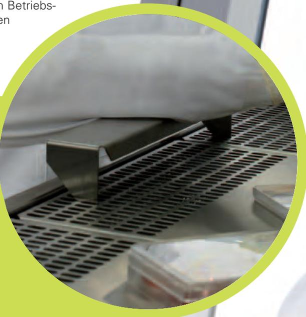
Sichere und komfortable Armauflagen unterstützen entspanntes Arbeiten im Innenraum und beugen Sehnenscheidenentzündungen vor. Durch ihre Position direkt über dem Luft-eintrittsgitter verhindern sie zudem, dass dieses durch den Benutzer unbeabsichtigt blockiert wird.
