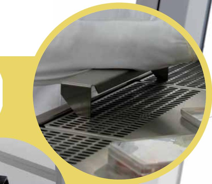
Sichere und komfortable Armauflagen unterstützen entspanntes Arbeiten im Innenraum und beugen Sehnenscheidenentzündungen vor. Durch ihre Position direkt über dem Luft-eintrittsgitter verhindern sie zudem, dass dieses durch den Benutzer unbeabsichtigt blockiert wird.
